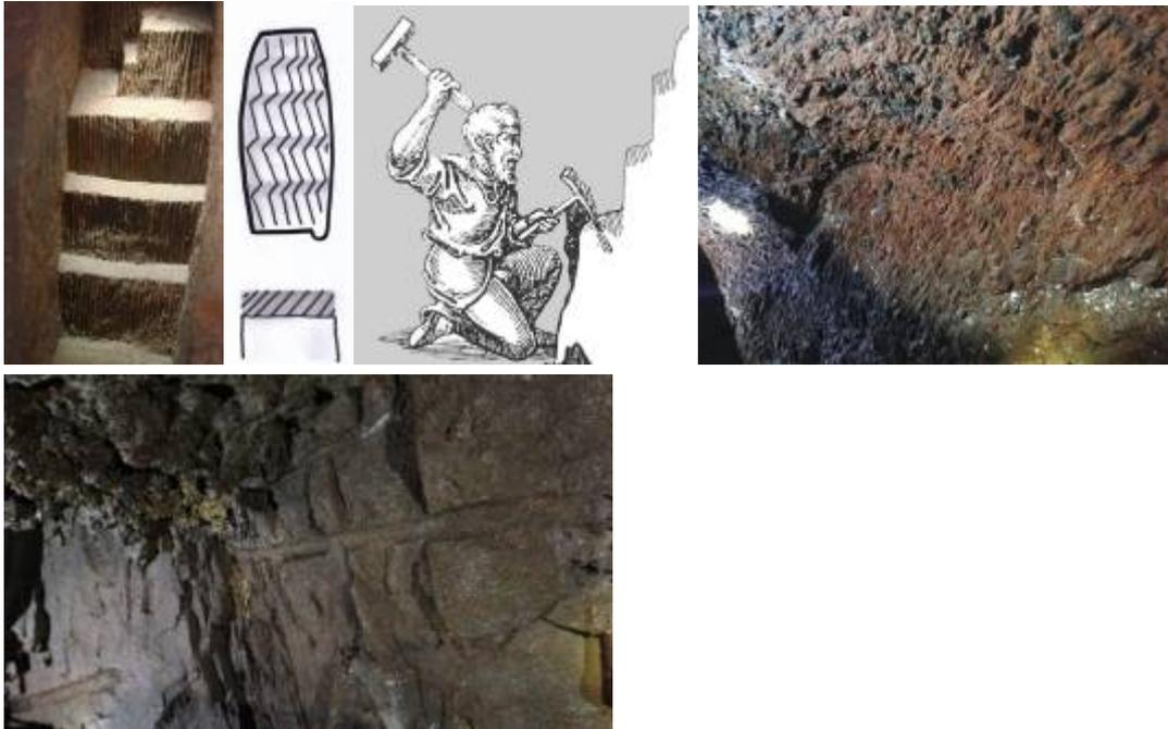
Bei dieser Stufenabbautechnik ist es nötig das Eisen exakt anzusetzen, damit der Anschnittwinkel und somit die Stufenform beibehalten wird. Deutlich sichtbar die Spuren der Schrämarbeit (hier: Wand glätten) mit Eisen und Schlägel im Wodanstolln (Siegerland, Neunkirchen-Salchendorf).
