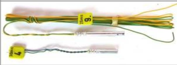
Momentzünder zünden sofort. Zeitzünder zünden mit verschiedenen Zeitstufen. Von 1 bis 18 reichten die Stufen, die Verwendung fanden. Mit Millisekundenzünder lässt sich bei der Sprengung eine stark zertrümmernde Wirkung des Erzes erreichen, sodass die Ladearbeit (Wegfüllarbeit) erleichtert wird.
