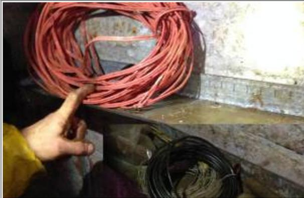
**Kennfarbe der Drähte** - Zünddrähte: Gelb/Grün, - Verbindungsdrähte: Weiß - Zündleitung 50m, ROT/ORANGE (Stegleitung aus Stahldraht). Die Kennfarbe kann je nach Empfindlichkeit der Sprengzünder abweichen.
