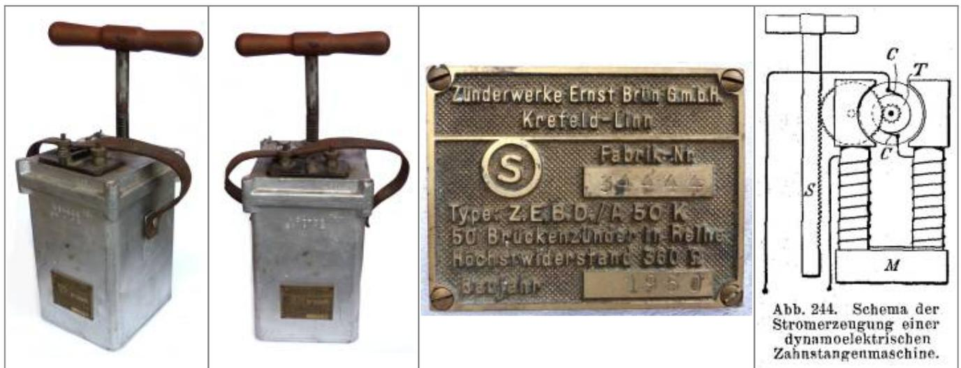
Auf der Vorderseite befindet sich ein Metallschild mit der Aufschrift: „Zünderwerke Ernst Brün G.m.b.H. Krefeld - Linn. Ein „S“ im Kreis (steht für Schlagwettersicherheit) Fabrik Nr. 34444 Type Z.E.B.D/A 50 K. 50 Brückenzünder in Reihe Höchstwiderstand 360 OHM Baujahr 1950
