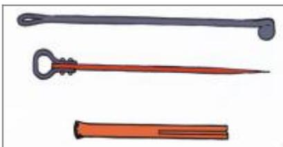
Werkzeug: Bohrlochkrätzer, Schießnadel, Bohrlochstampfer
