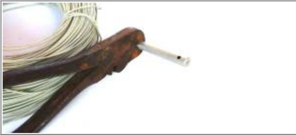
Zündhütchen ( fachlich besser Sprengkapseln) mit Knallquecksilber werden mit der Würgezange auf der Züandschnur angewürgt (festgeklemmt). Zu Beginn dieser Sprengmethode wird die Sicherheits-Züandschnur von William Bickford mit aufgedrehtem Zündhütchen (Zündkapseln/Sprengkapseln) verwendet.
