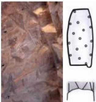
Auch bei dem irreführenden Begriff „Mehrlochsprengverfahren“ wird immer nur ein Bohrloch geschossen.
