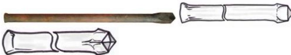
Kronenbohrer sind die älteren Vorläufer der einfachschneiden-Bohrer oder auch Meißelbohrer
