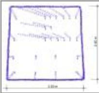
Bohr- und Schießschema für einen Abschlag, mit **fächerartigem Seiteneinbruch**. Die Bohrlöcher sind ca. 1,80 m tief gebohrt, so dass mit einem Schießeffekt von etwa 1,50 m gerechnet werden kann. Aufgrund des hohen Bohrlaufwands fiel das Haufwerk kleinstückig und ladegerecht an. Dieses Bohrverfahren wurde öfters angewandt.
