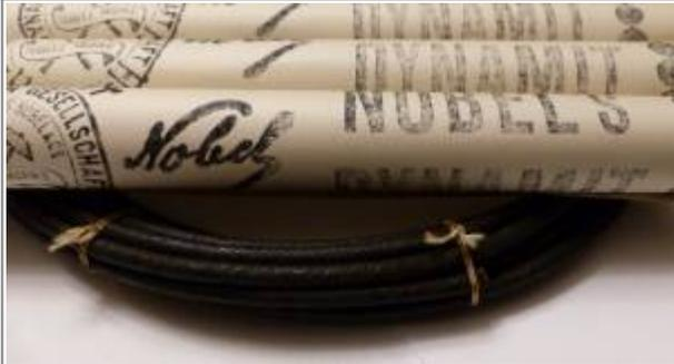
Dynamit besteht aus Nitroglyzerin und Kieselgur. Dynamit wurde später weiter entwickelt zu Gelatine-Dynamit. Ab etwa 1900 wurden Zeitzünder (Schnellzünder > Halbsekundenzünder > Millisekundenzünder) mit einem elektrischen Zündimpuls von der Zündmaschine aus, elektrisch gezündet.
