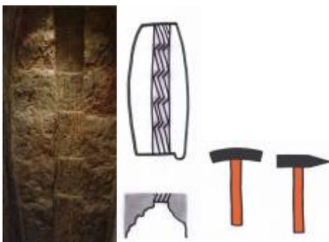
Die Bergleute schlagen unter Einsatz der Stufen-Abbautechnik einen schmalen Schnitt (Schram 15 bis 20cm breit) in den Abbaustoß. Rechts und links wird Holz für das Feuersetzen in Brand gesetzt um das Gestein brüchig zu machen.
