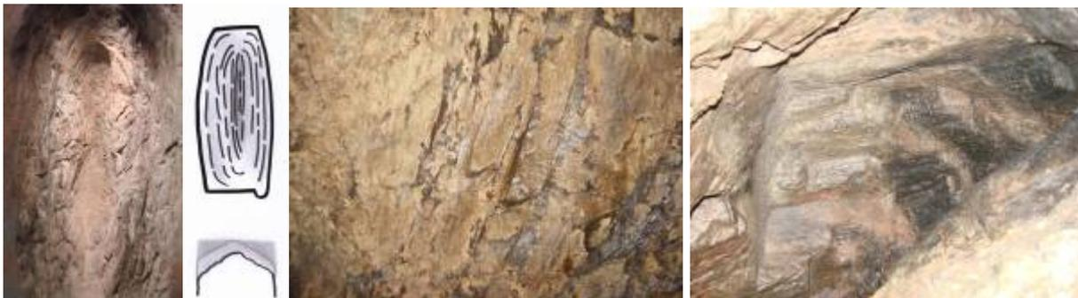
Vor dem Abbaustoß wird ein Holzfeuer entzündet. Dadurch wird die Gesteinsoberfläche brüchig und erleichtert den Abbau mit Eisen und Schlägel. Diese Methode jedoch benötigt sehr viel Feuerholz und eine ausreichende Luftzufuhr. Außerdem muss der Rauch des Feuers gut aus der Grube abziehen. Die Richtung des Stollens folgt meist einer Kluft. Noch heute sind Spuren des Feuersetzens in alten Stollen sichtbar. Die Vortriebsspuren liegen je nach Härte des Gesteins bei ca. 10 cm.
