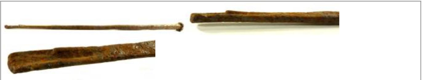
Angeblich soll dies ein Schwarzpulverlöffel sein um das Bohrloches zu befüllen (fraglich, eher Bohrlochstampfer)
