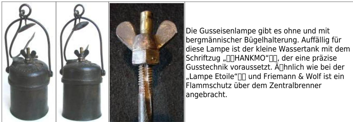
Die Lampe wiegt etwa 2,8 kg bei 10 cm Durchmesser und einer Höhe von 14 cm. Über die Nut in der Halteschraube gelangt das Acetylen gas in den Brenner. Bei den „Etoile-Lampen“ gelangt das Acetylen gas über eine durchgehende Bohrung zum Brenner. In der Friemann & Wolf - Lampe ist an Stelle der Nut eine Mittelbohrung mit seitlicher Freiboehrung zu sehen.
