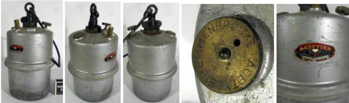
**Flügelmutter-Verschluss** von ACETYLEN-Truttmann in EMMENBRÜCKE / Schweiz. Beschriftet auf Wassertankdeckel und Stellschraube mit ACETYLEN-EMENBRÜCKE. Karbid-Grubenlampe Modell 516 mit Flügelmutter-Verschluss, deren ringförmiger Griff als Halterung für den Haken dient. Baujahr um 1950. Mit Original-Anleitung mit Händlerstempel Prevost aus Thusis, Schweiz.
