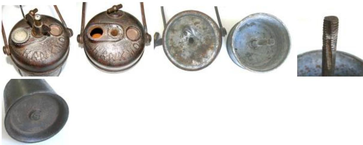
Aus gießtechnischen Gründen sind im Wassertank zwei größere Öffnungen angelegt. Während eine Öffnung mit einem Blindstopfen verschlossen wurde dient die andere Öffnung zum Befüllen. Der Verschlussstopfen wurde aus Zinn extra für diese Lampe gefertigt.
