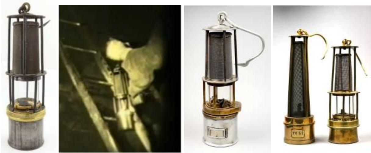
In Deutschland werden, nach großen Grubenunglücken, ab 1924 nur noch elektrische Handlampen als Mannschaftsgeleucht im Steinkohlenbergbau eingesetzt. Benzin-Sicherheitslampen dienen ausschließlich den Steigern zum Ableuchten der Firste.
