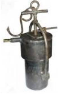
Karbidlampe mit seitlich verlegtem "Wasser-Verteil-Rohr"
