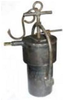
Karbidlampe mit seitlich verlegtem "Wasser-Verteil-Rohr"
