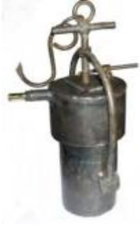
Karbidlampe mit seitlich verlegtem "Wasser-Verteil-Rohr"
