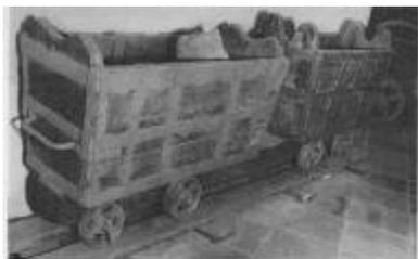
Abb. 15 Zwei alte Grubenhunte. Deutlich erkennbar die Breitergeleise. Die Hunte laufen hier bereits auf niedrigen Rillern. Ursprünglich waren sie einstufige Rollen wie Elben. Die Spornägel sind hier verloren gegangen.
