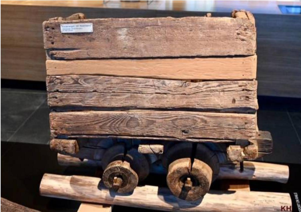
Dieser Kastenholz Hunt läuft auf Rundhölzern (Baumstämme) mit unterschiedlich großen Holzrädern ohne Spurnagel. Es stellt somit eine Zwischenstufe vom Spurnagelhunt und einen Kasten Hunt auf Schienen dar.
