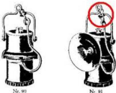
Unterschiedliche Ausführung der Verschlusshacken. Abbildungen von Butin, Hesse und Rötelmann.
