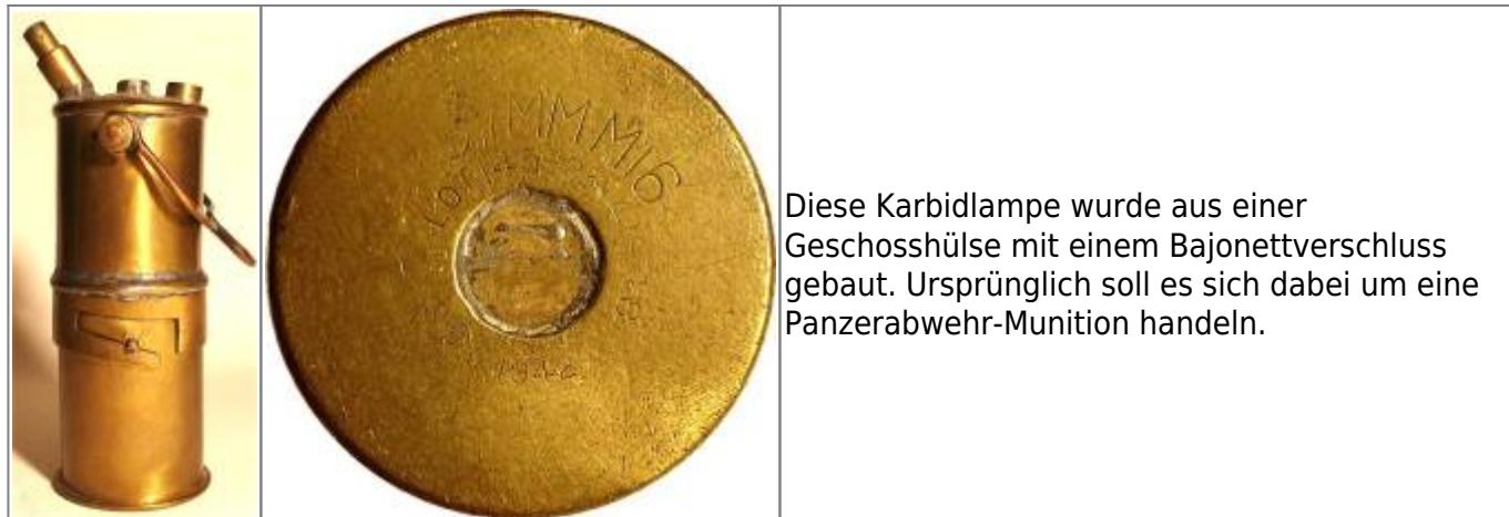
Diese Karbidlampe wurde aus einer Geschosshülse mit einem Bajonettschluss gebaut. Ursprünglich soll es sich dabei um eine Panzerabwehr-Munition handeln.
