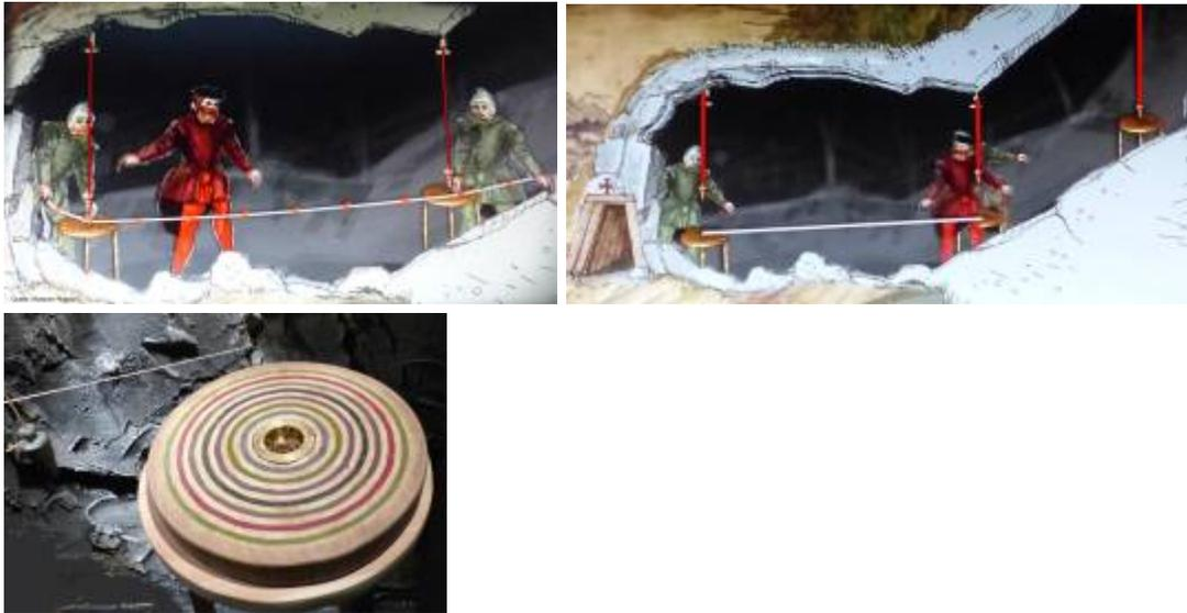
Früher konnte die Himmelsrichtung nur außerhalb der Stollens festgestellt werden. Im Stollen wurde eine Wachsscheibe bei Richtungswechseln unter Tage benutzt. Der Markscheider spannte die Messschnur von einer Biegung des Stollens bis zum nächsten Stollen, maß die die Länge und drückte die Schur in einen Farbkreis. Auf diese Art und Weise konnte er sieben verschiedene Winkel messen.
