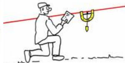
An die Schnur wurden der Gradbogen und der Kompass gehängt. Mit dem Gradbogen wurde die Neigung gegen den Horizont ermittelt und mit dem Kompass die Richtung gegen magnetisch Nord bestimmt. Anschließend bestimmte man mit der Lachterkette die Entfernung der einzelnen Punkte
