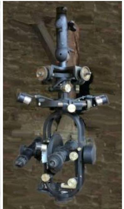
Ein Theodolit ist ein Winkelmessinstrument, das zur Messung von horizontalen und vertikalen Winkeln sehr eingesetzt wird. Hierzu wird er mittels eines Stativs über einem Punkt lotrecht aufgestellt. Eine Sonderbauform im Bergbau ist der Hängetheodolith. Die gewonnenen Daten werden anschließend in einer Karte zeichnerisch festhalten.
