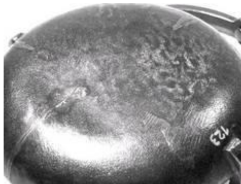
Klammerspuren vom Verlöten
