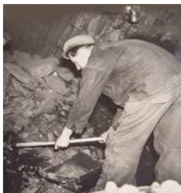
Arbeiten mit Kratze und Trog Hämatit
