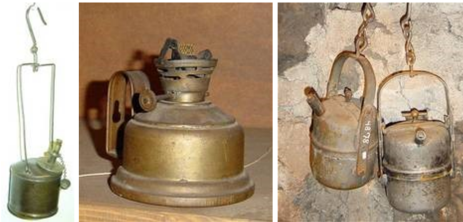
Norberglampe, Öllampe und zwei Karbidlampen der Firma Sigurd Stave aus Christiania (heute Oslo), ca. 1905
