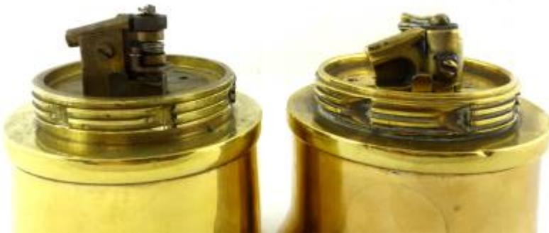
Lampen mit Metallfunkenzünder von Seippel (links mit Benzineinfüllung rechts hinten) und Friemann&Wolf (Benzineinfüllung links hinten) von vorne aus gesehen.
