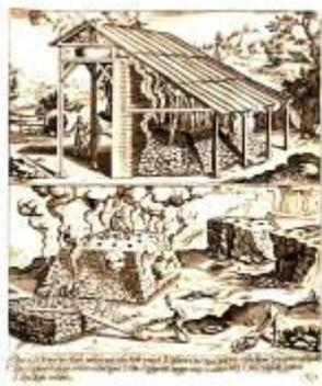
Bereits bei Agricola galt das „Rösten“ von Erz als eine wichtige Vorstufe zur Erzverhüttung. Beim Rösten wurde das Erz bis unter dem Schmelzpunkt erhitzt. Das Verfahren diente dazu, unerwünschte Bestandteile wie etwa Wasser und Schwefelbestandteile zu verdampfen. Das Rösten geschah im Röstbett oder Röstöfen. Auf Holzfeuern wurde das zerkleinerte Erz abwechselnd geschichtet und angezündet. Gegebenenfalls folgte ein zweiter oder dritter Röstprozess.
