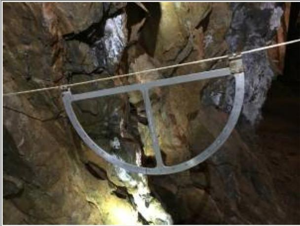
**Markscheider** vermessen die genaue Lage von Bodenschätzen. Mit Messinstrumenten und Kompass wurden die Grenzen des Bergwerks zu vermessen. So wurden genaue Karten über Gänge und Hohlräume im Bergwerk erstellt.
