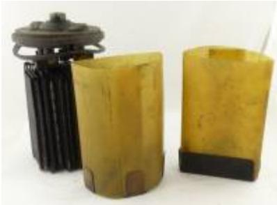
In den rechteckigen Plattenrahmen ist eingepresstes Kadmiumhydroxyd (Taschen), in den feingelochten vernickelten Stahlblechröhrchen (positive Platten) Nickelhydroxydul. (siehe Prospektblatt Dominit, Seite 8)
