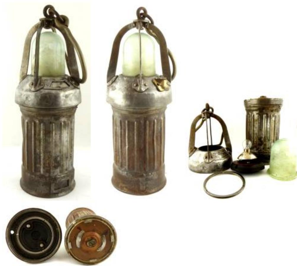
Anmerkung: Die Kennzeichnung Dominit (oben), Friemann&Wolf (meist unten) und der Bezeichnung **EPL** steht für „Einheits-Panzer-Lampe“. Einheit deswegen, weil die Austauschbarkeit der Teile innerhalb verschiedener Hersteller möglich war (Ähnlich wie bei den Karbid-Einheitslampen). Anwendungsgebiete : Bergbau, Wehrmacht, Landebahnen,.... .
