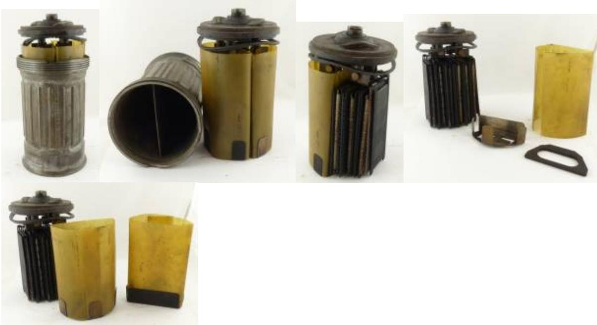
In den rechteckigen Plattenrahmen ist eingepresstes Kadmiumhydroxyd (Taschen), in den feingelochten vernickelten Stahlblechröhrchen (positive Platten) Nickelhydroxydul. (siehe Prospektblatt Dominit, Seite 8)
