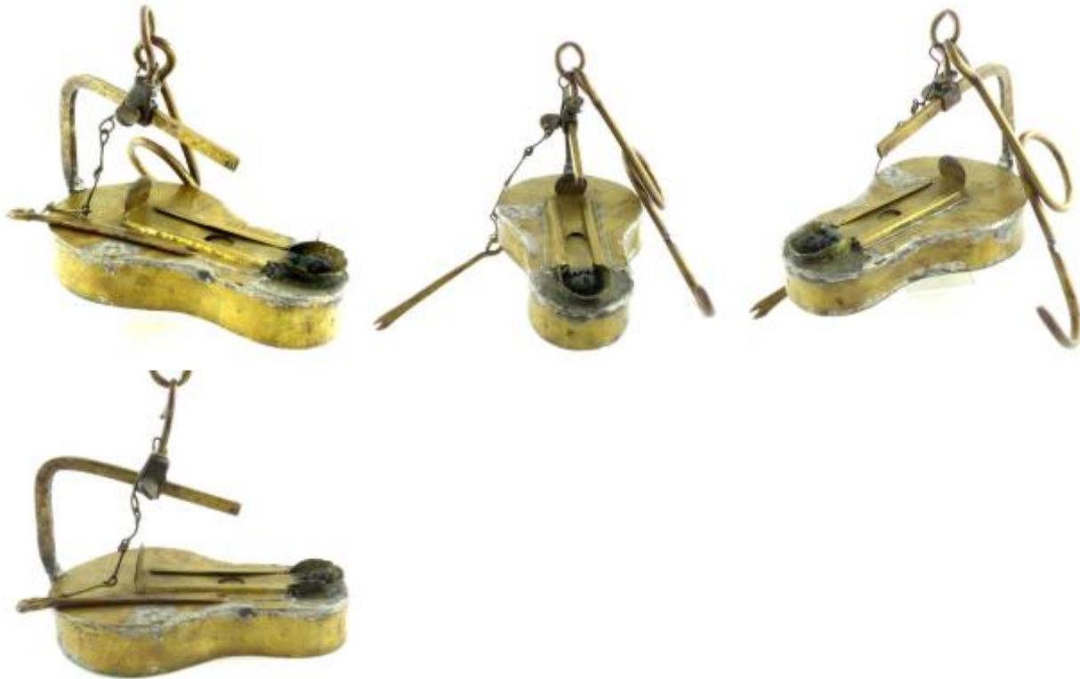
Geschlossene Froschlampe mit aufgelötetem Schiebeverschluss aus Messingblech. Tragbügel um 90 Grad abgewinkelt mit senkrechtstehender Ausformung. An einer ebenfalls rechteckigen Öse, die an dem Tragbügel festgeschraubt werden kann, ist der Traghaken befestigt.
