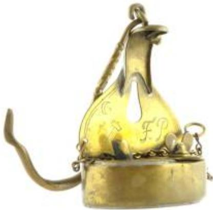
Die aufwendige Konstruktion aus Messing, die Verzierungen und Gravuren deuten auf die Nutzung durch einen höhergestelltten Bergbeamten hin. Diese benutzten eisenfreie Lampen.
