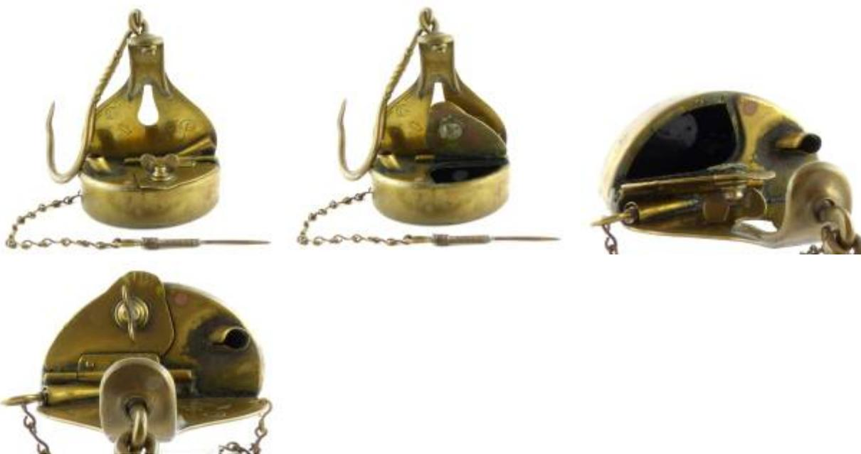
Die Gesamtkonstruktion, die Anordnung der Dochttülle zur besseren Ablesung bei Kompass und Theodolit und Aufhängung, können mit den Tätigkeiten eines Markscheiders in Verbindung gebracht werden. Zusätzlich war es natürlich auch möglich die Lampe in der Steigerstube an der Wand zu fixieren. Die Lampe wurde gefahren, was die Abnutzungsspuren der Trageösen zeigen. Die Mondsichel spricht für den Silberbergbau in Schwaz/Tirol.
