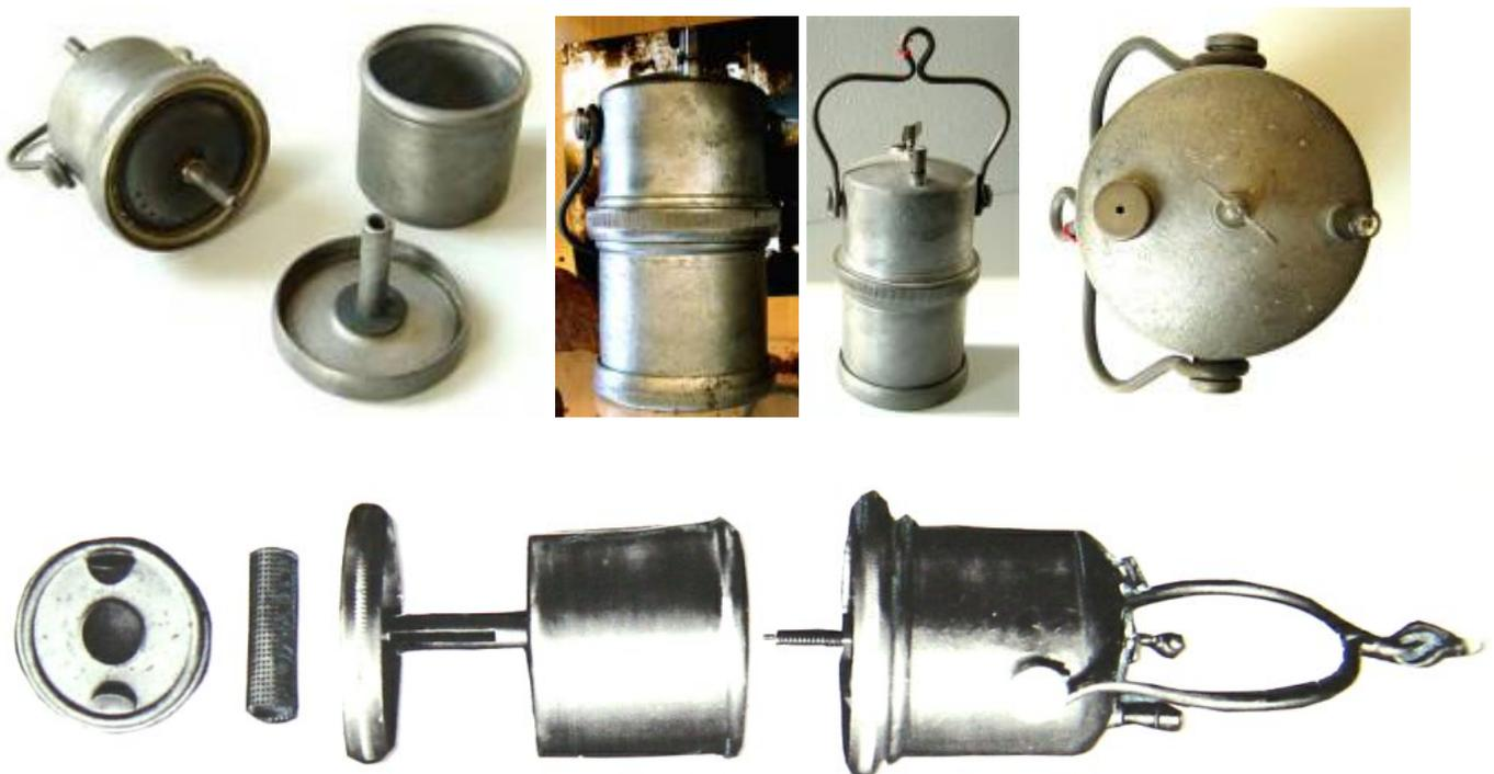
Diese gut konzipierten Excelsior-Lampen hatten einen Nachteil. Die Zentralschraube lies sich durch die Oxidation und Verschmutzung schwer öffnen. Darum entwickelte Pierre Schiltz (1912) die erste
