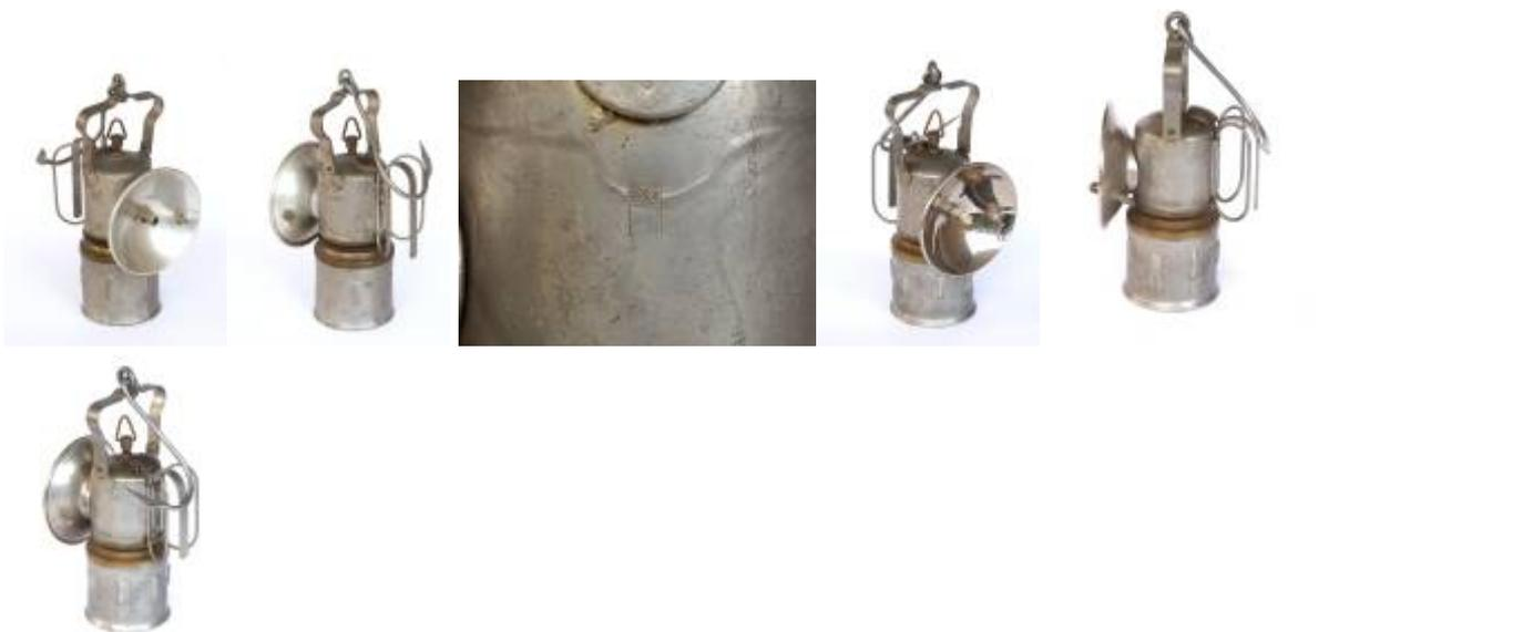
**Modell 124:** zunächst großer zweisechalig-einteiliger, angeschraubter Parabolreflektor, später zweiteilig-einschaliger Parabolreflektor, dreieckiger, klappbarer Wasserspindelgriff, Rückenhaken und hintere Handgriffe, Karbidbehälter mit 7 Rippen 1939-1950
