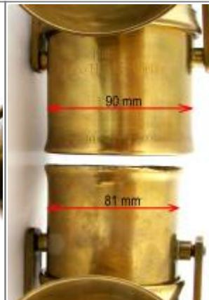
Die Lampe von Petri hat einen größeren Lampentopfdurchmesser als die Beamtenlampe von Schweisfurth. Diese ist auch in der Höhe des Wassertopfs und des Karbidtopfs niedriger. Die Petri-Lampe hat zur Druckplatte hin eine runde Wassertankabdeckung. Der Abschluss der Schweisfurth-Lampe verläuft gerade.
