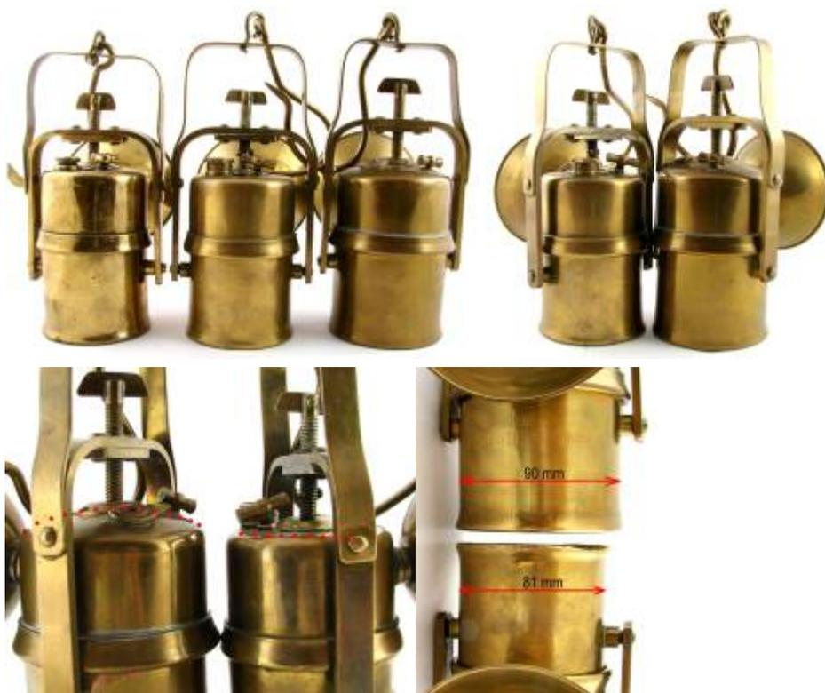
Die Lampe von Petri hat einen größeren Lampentopfdurchmesser als die Beamtenlampe von Schweisfurth. Diese ist auch in der Höhe des Wassertopfs und des Karbidtopfs niedriger. Die Petri-Lampe hat zur Druckplatte hin eine runde Wassertankabdeckung. Der Abschluss der Schweisfurth-Lampe verläuft gerade.
