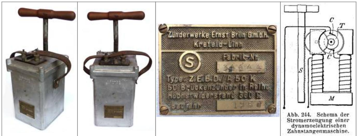
Auf der Vorderseite befindet sich ein Metallschild mit der Aufschrift: „Zünderwerke Ernst Brün G.m.b.H. Krefeld – Linn. Ein „S“ im Kreis (steht für Schlagwettersicherheit) Fabrik Nr. 34444 Type Z.E.E.B.D/A 50 K. 50 Brückenzünder in Reihe Höchstwiderstand 360 OHM Baujahr 1950
