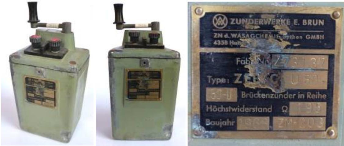
„Kondensator-Zündmaschinen sind tragbare Vorrichtungen zur Auslösung elektrischer Sprengzünder. Die Zündmaschinen der ZEB bestehen im Wesentlichen aus einem Generator, Kondensator und der Auslöseeinrichtung. Der Generator erzeugt Energie (z.B. durch Betätigen einer Handkurbel), die dem Kondensator zugeführt und dort gespeichert wird. Zum Zünden wird der geladene Kondensator über die Auslöseeinrichtung (etwa Drucktaster, hängt vom Zündmaschinen Typ ab) in den Zündkreis geschaltet.“
