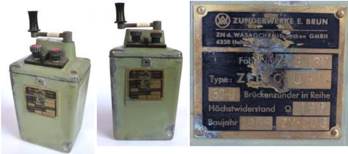
„Kondensator-Zündmaschinen sind tragbare Vorrichtungen zur Auslösung elektrischer Sprengzünder. Die Zündmaschinen der ZEB bestehen im Wesentlichen aus einem Generator, Kondensator und der Auslöseeinrichtung. Der Generator erzeugt Energie (z.B. durch Betätigen einer Handkurbel), die dem Kondensator zugeführt und dort gespeichert wird. Zum Zünden wird der geladene Kondensator über die Auslöseeinrichtung (etwa Drucktaster, hängt vom Zündmaschinen Typ ab) in den Zündkreis geschaltet.“
